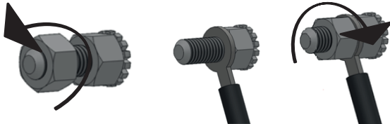
Rys. 4. Podłączenie urządzenia do instalacji wyrównującej potencjały elektryczne.
