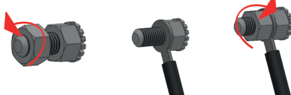
Rys. 4. Podłączenie urządzenia do instalacji wyrównującej potencjały elektryczne.
