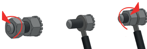
Figura 4. Conexión del equipo a una instalación equipotencial.
