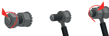
Fig. 4. Raccordement de l'appareil à une installation équipotentielle.
