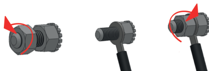
Obrázek č. 4. Připojení přístroje k zařízení pro vyrovnávání potenciálu.
